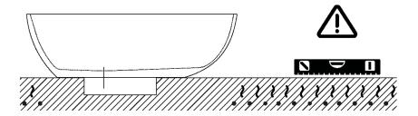
La vasca deve essere installata su un pavimento perfettamente piano. The bathtub must be positioned on a flat floor surface.
