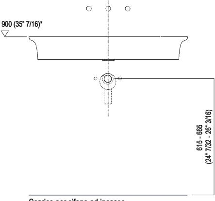
Scarico per sifone ad incasso Drain for concealed waste trap
