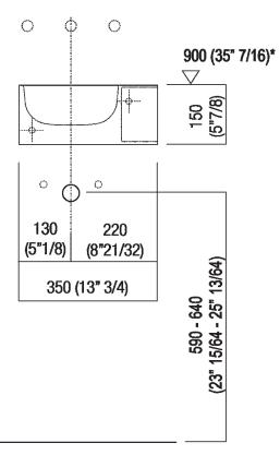
Scarico per sifone a bottiglia Drain for bottle trap
