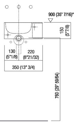
Scarico per sifone ad incasso e piletta con canotto fisso Drain for concealed waste trap with not adjustable pipe
