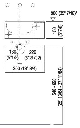
Scarico per sifone ad incasso Drain for concealed waste trap
