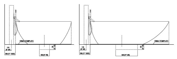
Per un corretto posizionamento del pozzetto e della rubinetteria è necessario utilizzare la dima in cartone con sagoma uguale al profilo superiore della vasca.
