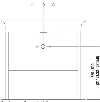
Scarico per sifone a bottiglia Drain for bottle trap
