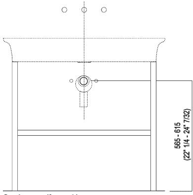
Scarico per sifone ad incasso Drain for concealed waste trap
