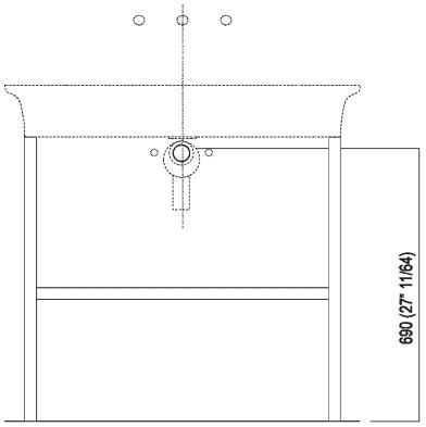
Scarico per sifone ad incasso e piletta con canotto fisso Drain for concealed waste trap with not adjustable pipe
