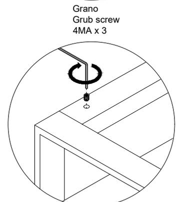
**4.1** Montaggio del profilo estruso di collegamento anteriore
