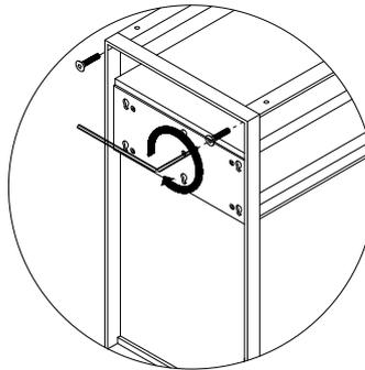
**5.2** Montaggio del profilo estruso di collegamento inferiore e dei tappi di finitura
