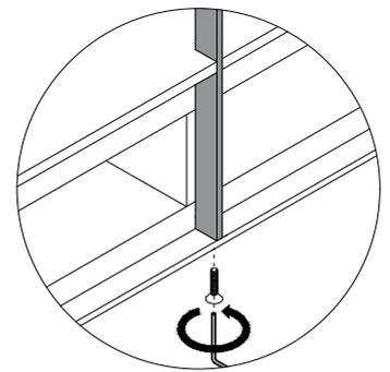
**3.2** Montaggio del profilo estruso di collegamento posteriore
