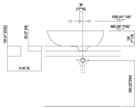
Scarico per sifone ad incasso Drain for concealed waste trap
