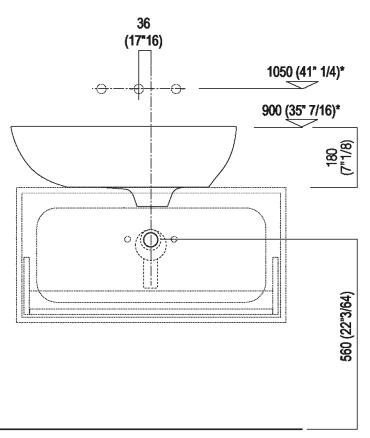
Scarico per sifone a bottiglia o ad incasso Drain for bottle trap or concealed waste trap
