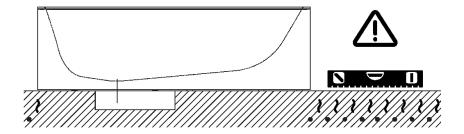
La vasca deve essere installata su un pavimento perfettamente piano. The bathtub must be positioned on a flat floor surface.
