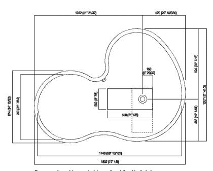
Per un corretto posizionamento del pozzetto e della rubinetteria è necessario utilizzare la dima in cartone con sagoma uguale al profilo superiore della vasca.
