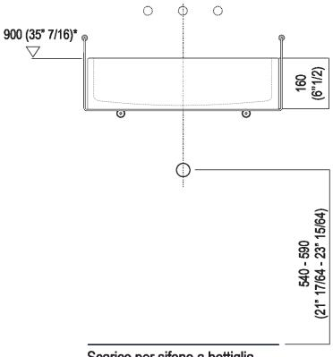
Scarico per sifone a bottiglia Drain for bottle trap
