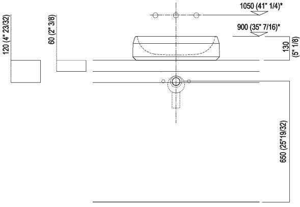
Scarico per sifone ad incasso Drain for concealed waste trap
