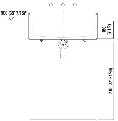
Scarico per sifone ad incasso e piletta con canotto fisso Drain for concealed waste trap with not adjustable pipe
