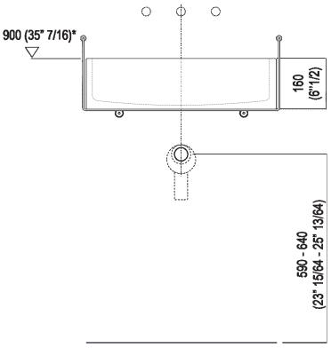
Scarico per sifone ad incasso Drain for concealed waste trap
