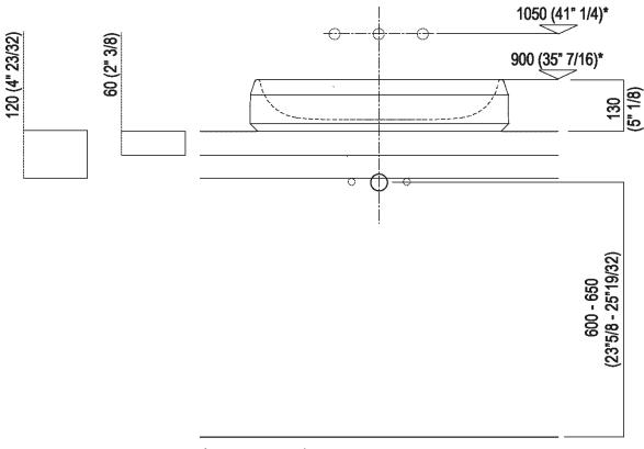
Scarico per sifone a bottiglia Drain for bottle trap
