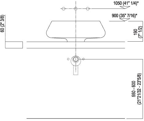
Scarico per sifone ad incasso Drain for concealed waste trap
