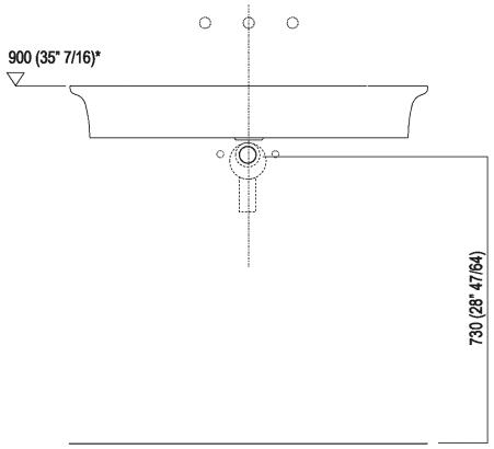
Scarico per sifone ad incasso e piletta con canotto fisso Drain for concealed waste trap with not adjustable pipe
