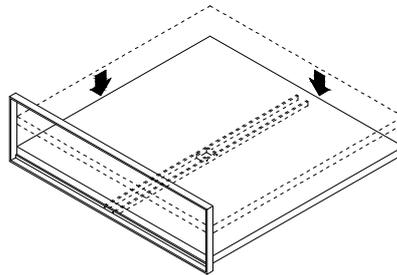
Posizionare il sottotop sul profilo estruso di collegamento inferiore
