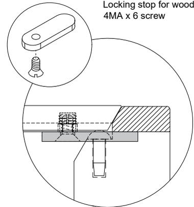
**1.1** Fissaggio del profilo estruso di collegamento inferiore al fianco laterale
